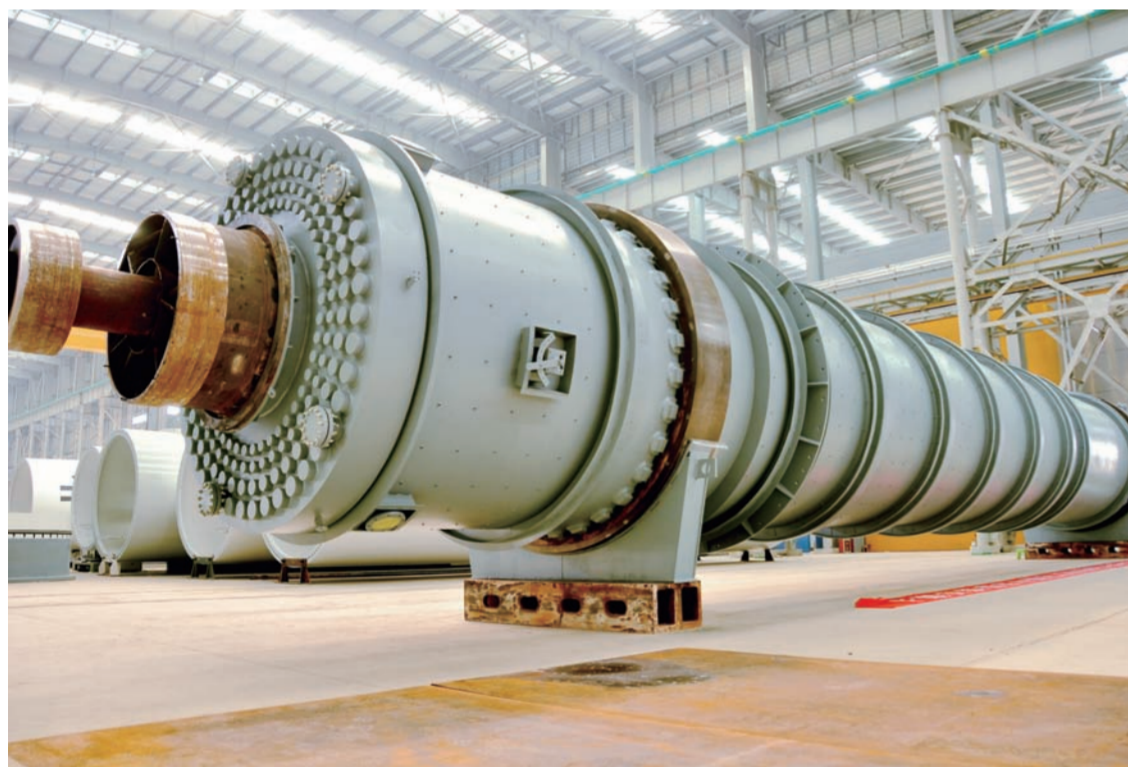
近日,中建安装化工设备公司出口印度的纯碱煅烧炉顺利完成制造并交付,突破公司化工板块“零出口”记录。该回转设备直径3.6米、长约29米、总重220吨,其进料端面、滚圈等回转部位,对椭圆度和直线度要求高,需要控制在2毫米以内,工艺复杂、加工难度大。(徐海燕 吉怀军)
