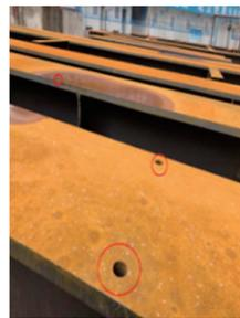
钢梁翼缘板上取代吊耳的“吊眼”
