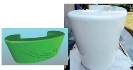
接待台先经CAD设计（左图），然后由3D打印企业建模，最终由光滑玲珑、造型特异的接待台被“打印”出来（右图）。
