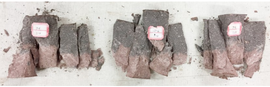
破坏性试验纹理等同混凝土试块
