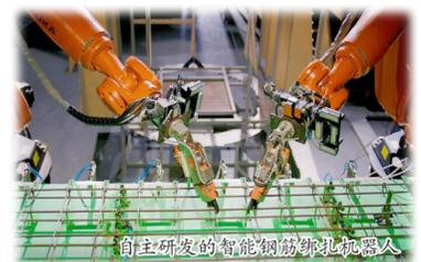
自主研发的智能钢筋绑扎机器人
