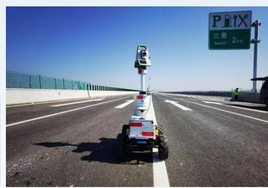
高精度测量机器人
